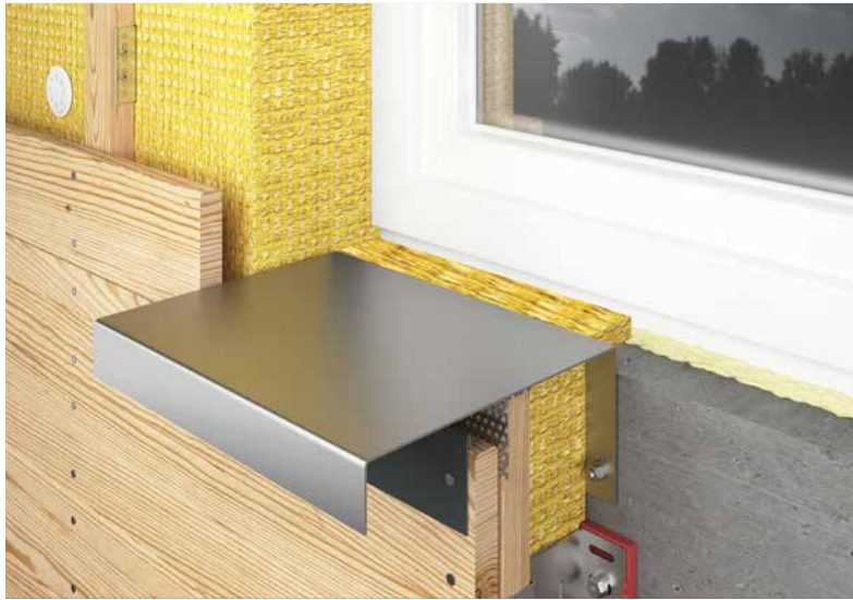
Bild 73 • Montering perforerad plåt och fästremor
