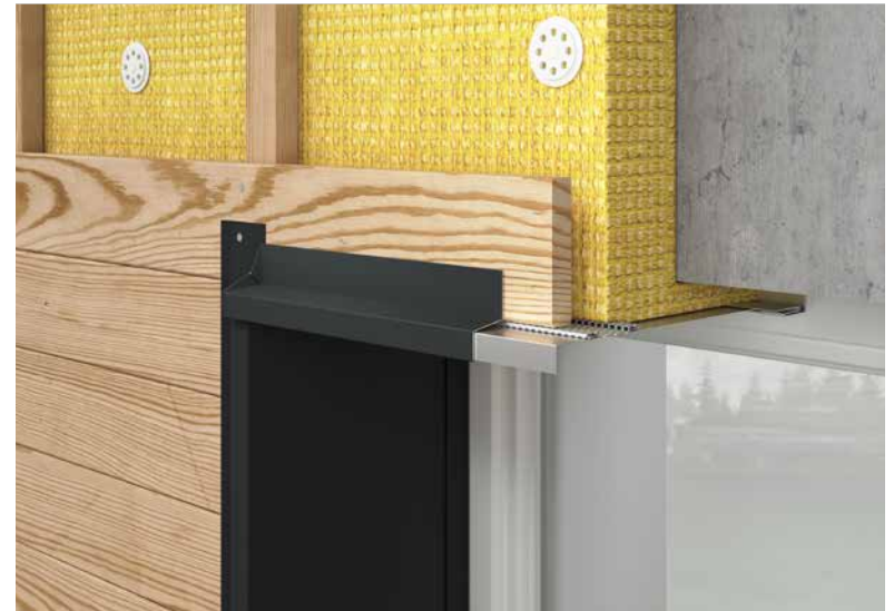
Bild 82 • Montering droppbleck överliggare
