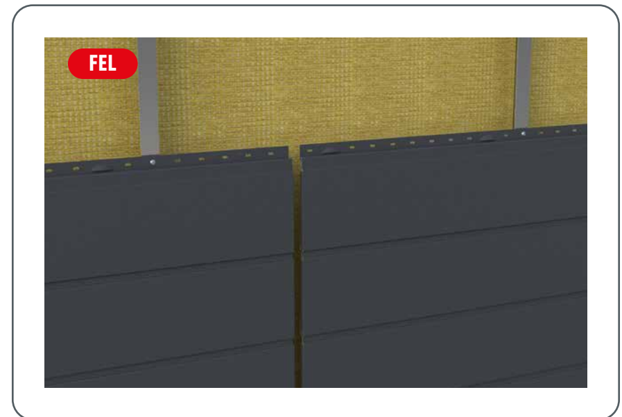
Bild 92 • Öppna stötfogar ej OK
