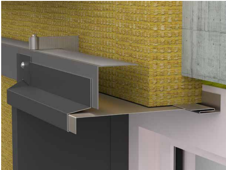
Bild 101 • Montering droppbleck överliggare
