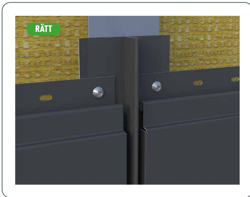
Bild 91 • Montering med stötplåt
