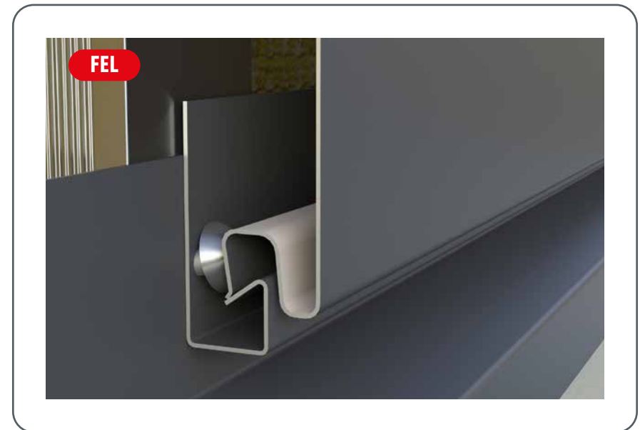
Bild 77 • Ej korrekt infästning av startprofil
