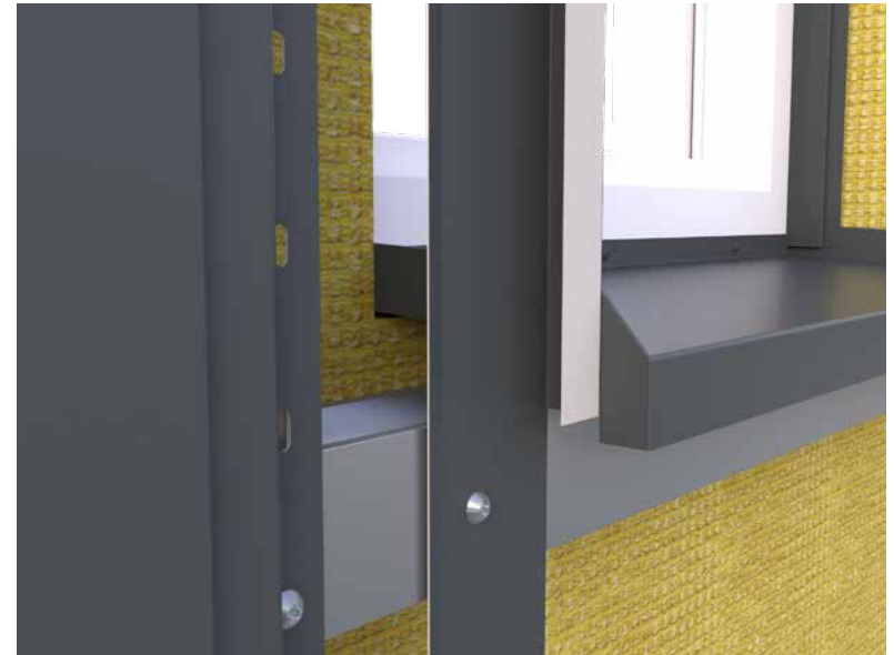
Bild 96 • Montering vinkelbeslag fönstersmyg
