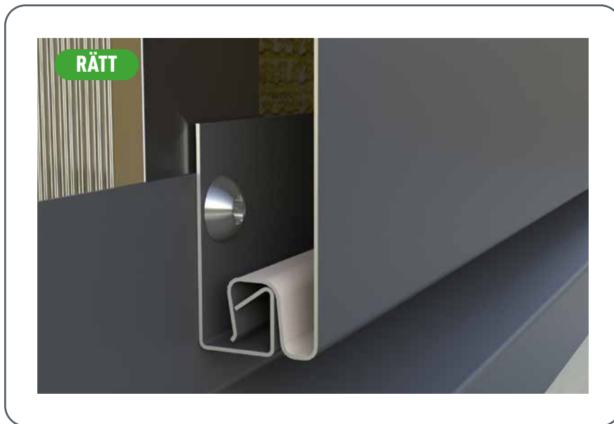
Bild 76 • Korrekt infästning av startprofil
