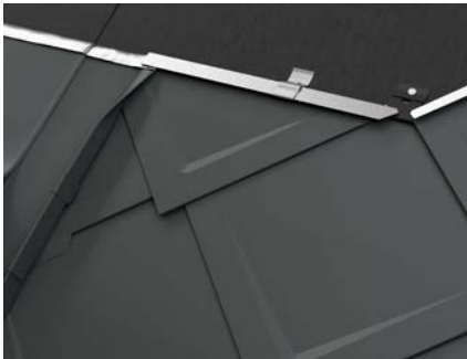
Bild 112 • Taklucka – särskilt förfarande vid takromb 29 × 29 och 44 × 44
